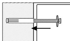
Montagebeispiel mit einer Klemm-/Spreizschraube. Zur Verwendung bei einer Holzwand.
