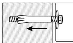
Montagebeispiel mit einem Dübel und einer Schlossschraube. Zur Verwendung bei einer Betonwand.
