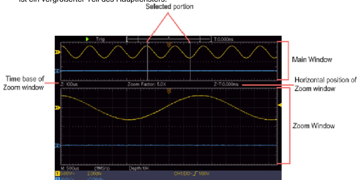
Im normalen Modus werden die Regler für horizontale Position und horizontale Skalierung verwendet, um die horizontale Position und die Zeitbasis des Hauptfensters einzustellen.
