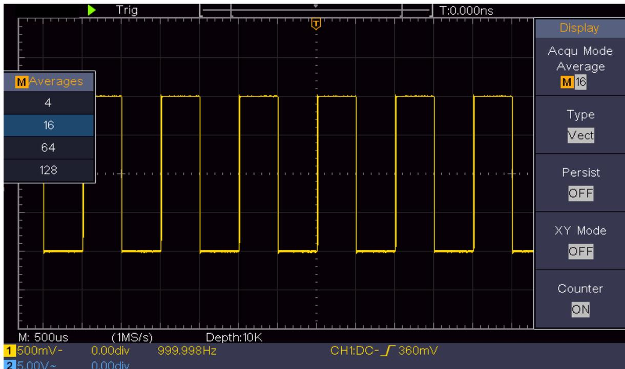
Abbildung 6–5 Reduzierter Rauschpegel mithilfe der Funktion Averages (Mittelwert)
