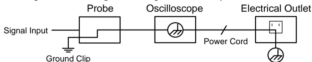
**Messen Sie keine AC-Wechselspannungen, wenn das Oszilloskop selbst mit AC Wechselspannung versorgt wird und an einen PC angeschlossen ist, welcher wiederum selbst mit einer AC Wechselspannung versorgt wird.**
