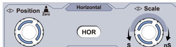
Abbildung 3 - 11 Horizontal Regelzone
