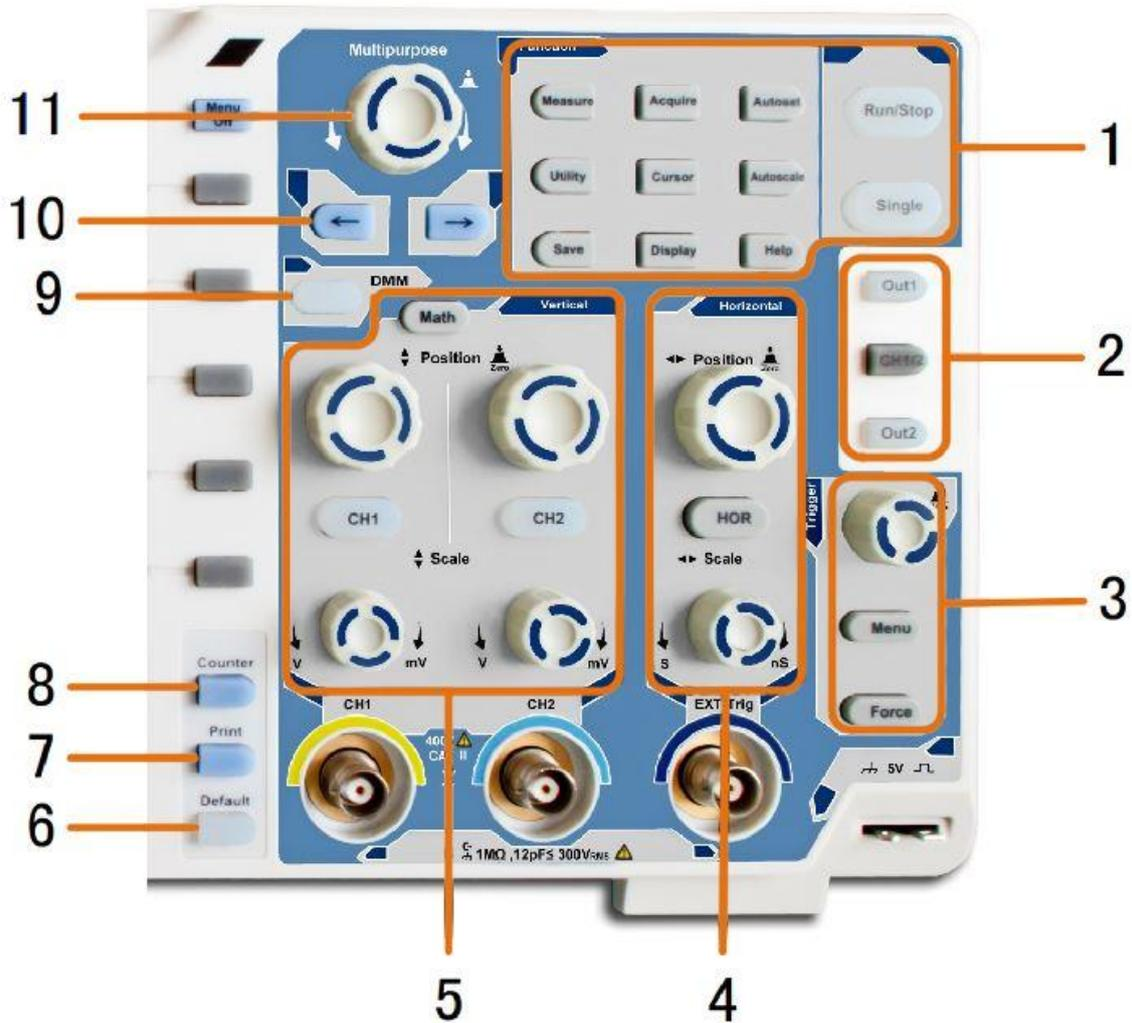
1. **Funktionstastenbereich:** Hauptsteuerung für alle Funktionsmenüs
