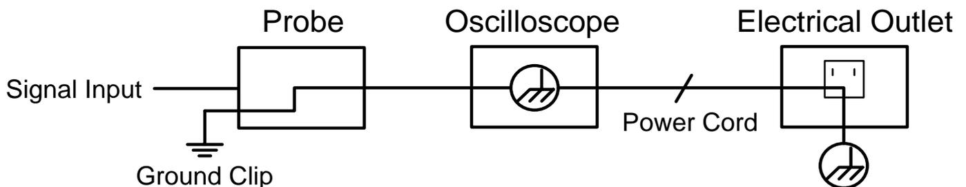
Durch die intern verbundenen Erdungsklemmen zwischen BNC-Buchse, USB-Port und Kaltgerätestecker sollte bei Netzspannungsbetrieb des Oszilloskops in Verbindung mit einem Netzspannungsbetriebenen PC keine Messung der Netzspannung durchgeführt werden. Im Fehlerfall könnte ein Spannungsüberschlag über den GND des PCs a
