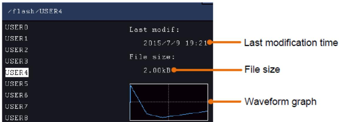
Ist ein USB-Speicher angeschlossen und Sie möchten die Wellenform auf diesem Speichern, wählen Sie **Memory** und dann **USB**. Das Gerät listet die Ordner auf dem USB-Speicher auf. Wählen Sie einen Ordner mit dem M-Drehknopf, um in der Liste auf- und ab zu scrollen. Um in den Ordner zu wechseln, wählen Sie **Change Dir** im rechten Menü. Wählen Sie dies nochmals, um im das übergeordnete Verzeichnis zu wechseln.
