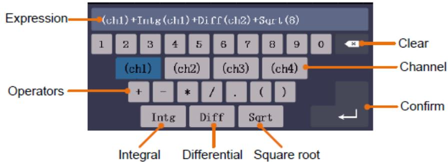
3. Erstellen Sie eine Darstellung. Wenn Sie fertig sind, wählen Sie ↵ auf der Tastatur zur Bestätigung. Die Division der Math-Wellenform wird am linken unteren Bildschirmrand angezeigt.
