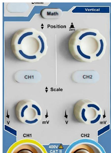
1. Mit dem Drehknopf „**VERTICAL POSITION**“ können Sie das Signal in der Mitte des Wellenform-Fensters darstellen. Mit dem Einstellknopf „**VERTICAL POSITION**“ stellen Sie die vertikale Anzeigeposition des Signals ein. Eine Drehung des Einstellknopfes „**VERTICAL POSITION**“ bewegt den Zeiger der Nullpunktposition des Kanals nach oben und unten, der Wellenform folgend.
