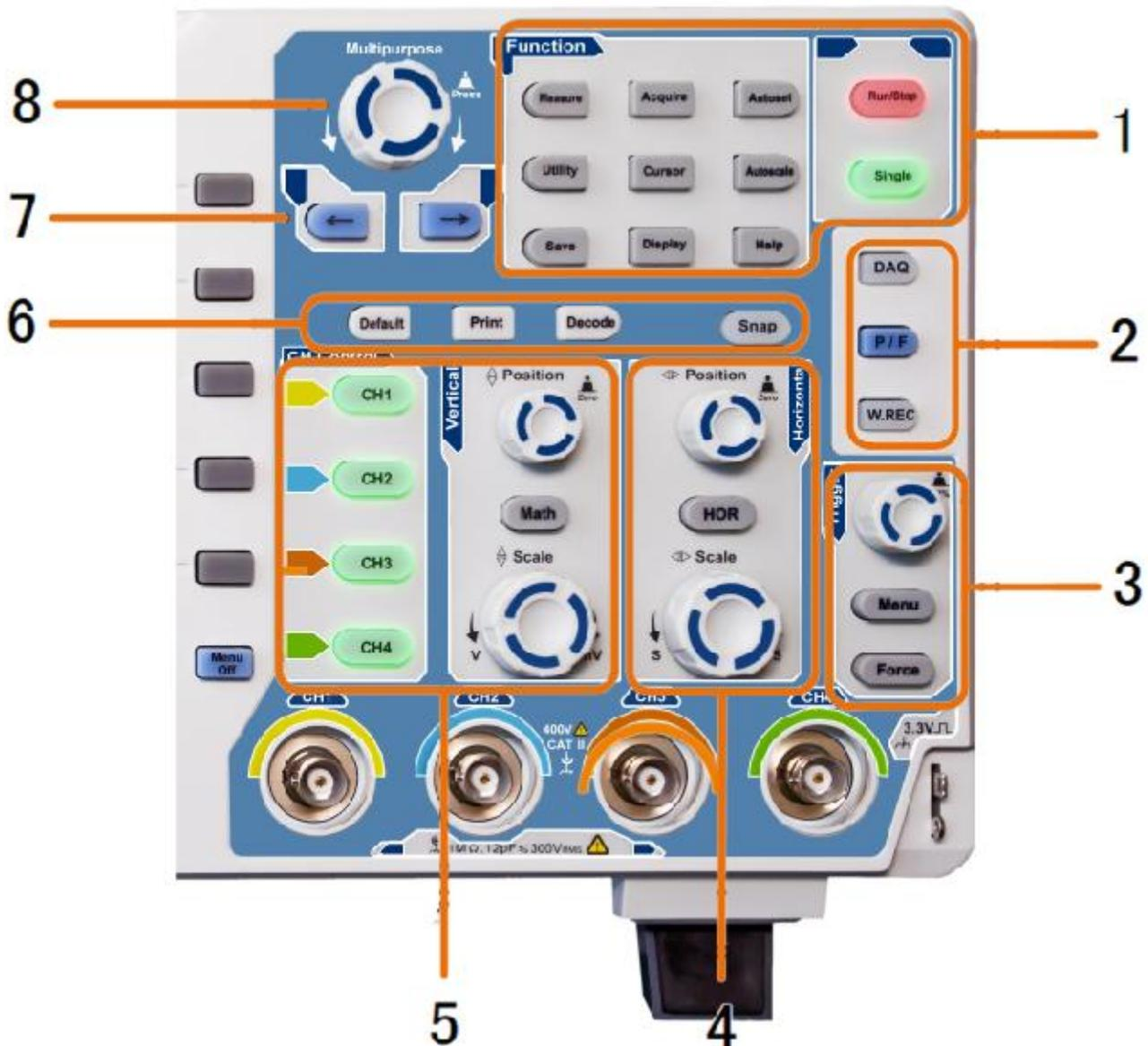
1. **Funktionstastenbereich:** Hauptsteuerung für alle Funktionsmenüs
