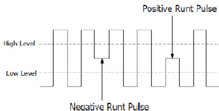
Im Runt-Trigger Modus wird die Einstellungsinformation am unteren rechten Bildrand dargestellt, z.B.: **CH1: $\square$  $\Delta$ 0.00mV** zeigt an, das der Runt-Trigger auf CH1 mit positiver Polarität ausgewählt wurde und die Differenz zwischen dem Up-Level und Low-Level Schwellenwert 0.00mV beträgt.
