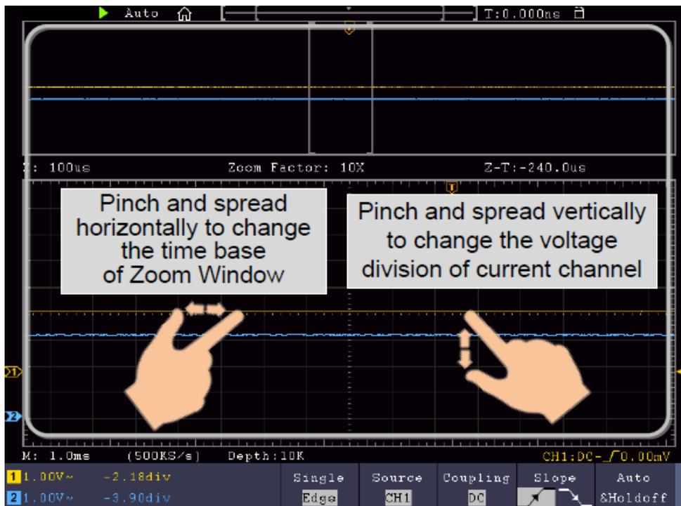
Im Zoom-Fenster gleichzeitig nach links/rechts wischen, um horizontale Zeitbasis zu ändern und gleichzeitig nach oben/unten wischen, um vertikale Volt/Division zu ändern.
