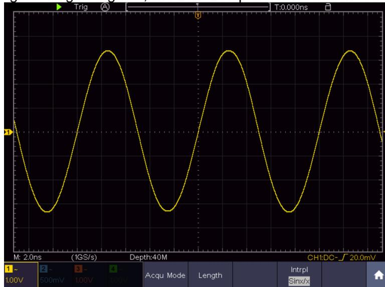
Bild 4-3 Sine(x)/x Interpolation
