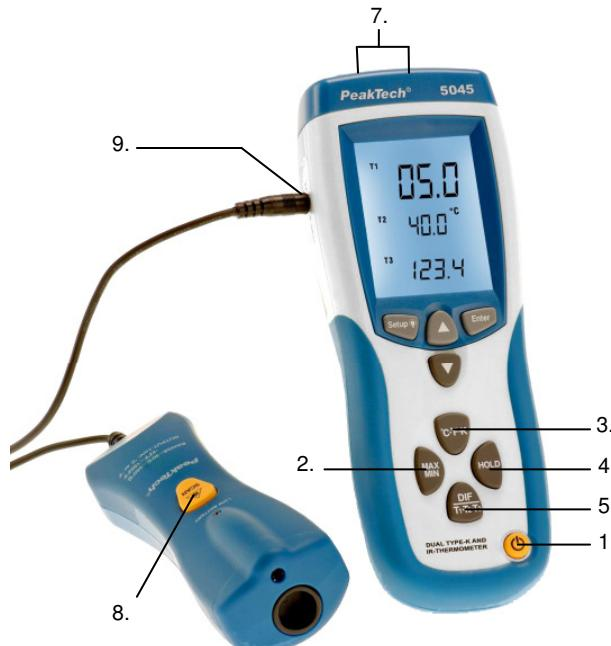
1. Klawisz wł. / Wył., Aby włączyć lub wyłączyć instrument
