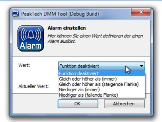
Sie können definieren, ob der Alarm immer ausgelöst wird (sobald ein Messwert den eingestellten Bereich über-/unterschreitet oder nur dann, wenn der Messwert sich erhöht [steigende Flanke] oder verringert [fallende Flanke]).
